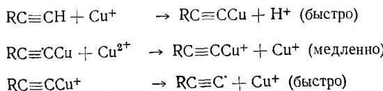
Анализ данных по окислительной конденсации ацетиленовых соединений создает впечатление о возможности существования трех различных механизмов димеризации в щелочной среде, приводящих к аналогичному результату: окисление ацетиленид-иона, окисление ацетилененида одновалентной меди и, наконец, образование нестабильного ацетиленового производного двухвалентной меди, распадающегося на ацетиленовый радикал и соль одновалентной меди.
