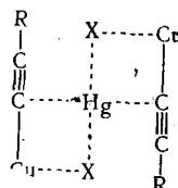
Если комплекс построен из подобных фрагментов, связанных между собой за счет координации  $\pi$ -электронов тройных связей с атомами меди, то уже для димера находят объяснение две полосы валентных колебаний тройной связи в его ИК спектре.
