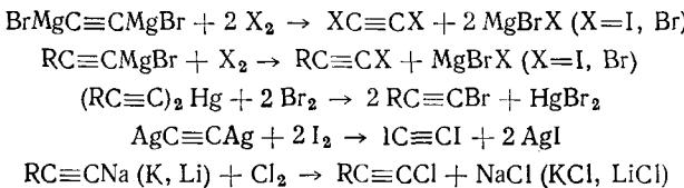
Во всех этих случаях взаимодействие протекает как конкуренция галогена с металлом за перераспределение электронов уже имеющейся связи металл — углерод, так как металлы (исключая серебро) находятся в своих высших окислительных состояниях.
