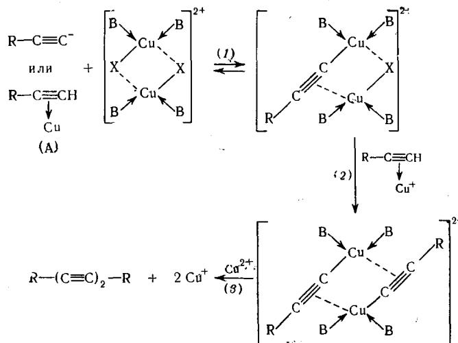
В кислой среде ацетиленид одновалентной меди может образоваться только в виде  $\pi$ -комплекса (A), который далее реагирует по (1). Благодаря увеличенной кислотности комплекса (A), а также при увеличении концентрации  $\text{Cu}^{2+}$ , реакция будет смещена вправо, в сторону образования диацетиленового производного.
